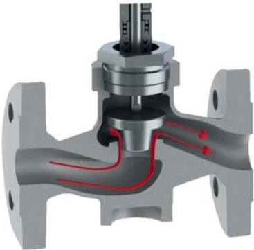
Pour influencer avec souplesse le débit volumétrique dans une tuyauterie, une simple commande Tout ou Rien ne suffit pas. Le débit volumétrique doit être réglé avec précision à l'intérieur d'une plage adaptée aux tâches de régulation. Pour répondre à cette exigence, il est nécessaire d'utiliser des vannes à clapets de régulation au lieu des clapets usuels. Ces vannes peuvent être conçues et fabriquées selon l'application afin d'obtenir les caractéristiques de régulation souhaitées.
